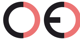
Falsche CE-Kennzeichnung (zu großer Zwischenraum)
